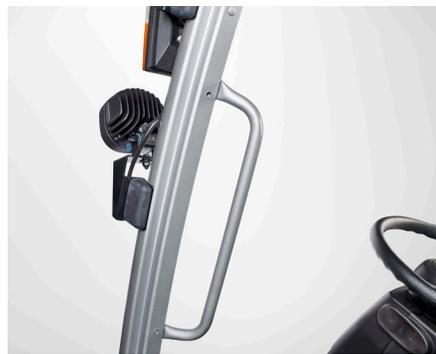
Eine niedrige Einstiegshöhe, ein großer Griff als Einstiegshilfe und der großzügige Fußraum sorgen für bequemen Zugang zur Fahrerkabine. An Bord des M300 steht eine Reihe von mechanischen oder elektronischen Steuerelementen zur Auswahl, wogegen der M300H entweder über Minihebel oder Mini-Joysticks bedient wird.
